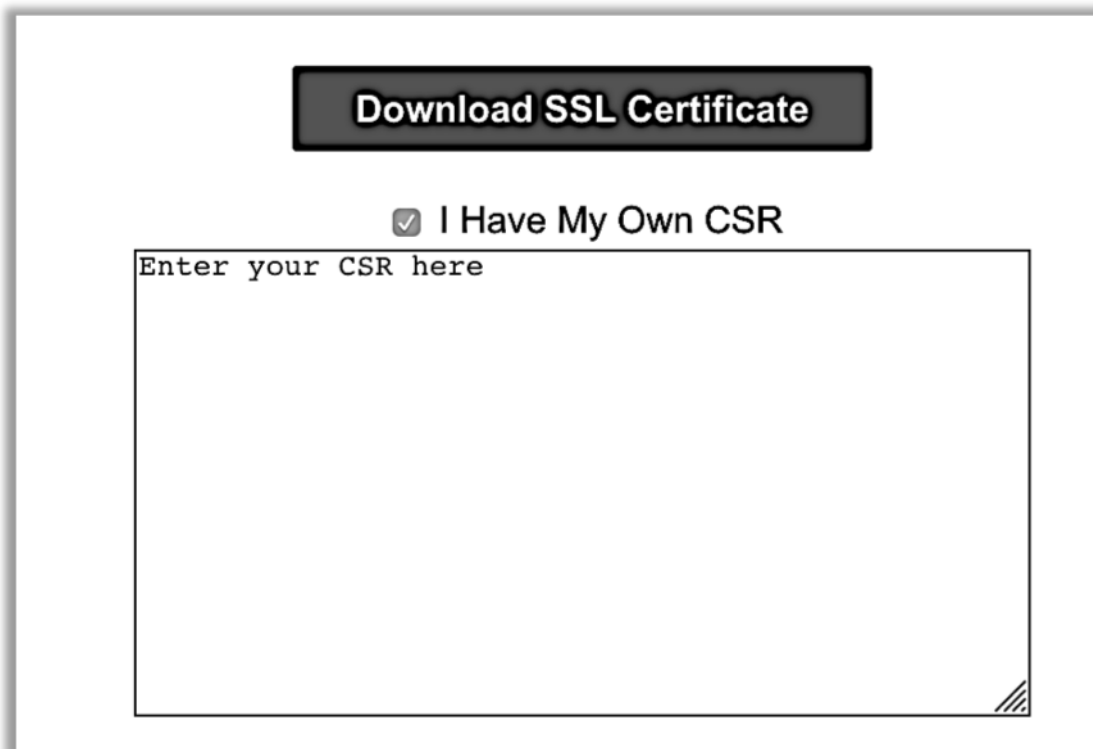
Рис. 4. Достаточно скопировать CSR в предназначенное для этого поле и нажать "Download SSL Certificate"
